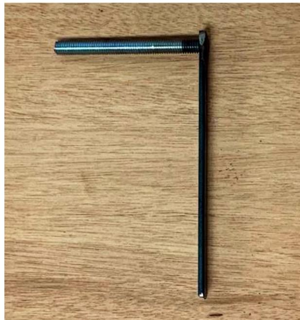
Após a soldagem do eixo, o mesmo deve ser cortado no comprimento de 15mm aproximadamente, o suficiente para a fixação da roldana com uma porca.
