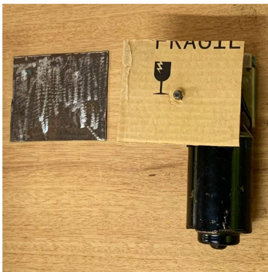
Coloque o papelão novamente no motor, passando o eixo pelo furo. Centralize o motor na posição desejada e pressione o papelão contra as entradas dos parafusos do motor, para que suas posições também fiquem marcadas no mesmo.
