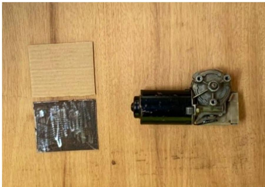
Alinhe o pedaço de papelão de forma que o motor fique na posição desejada, e pressione-o para que o eixo faça uma marca no papelão. Com uma broca no diâmetro do eixo ou uma broca escalonada, perfure o papelão no local marcado pelo eixo.
