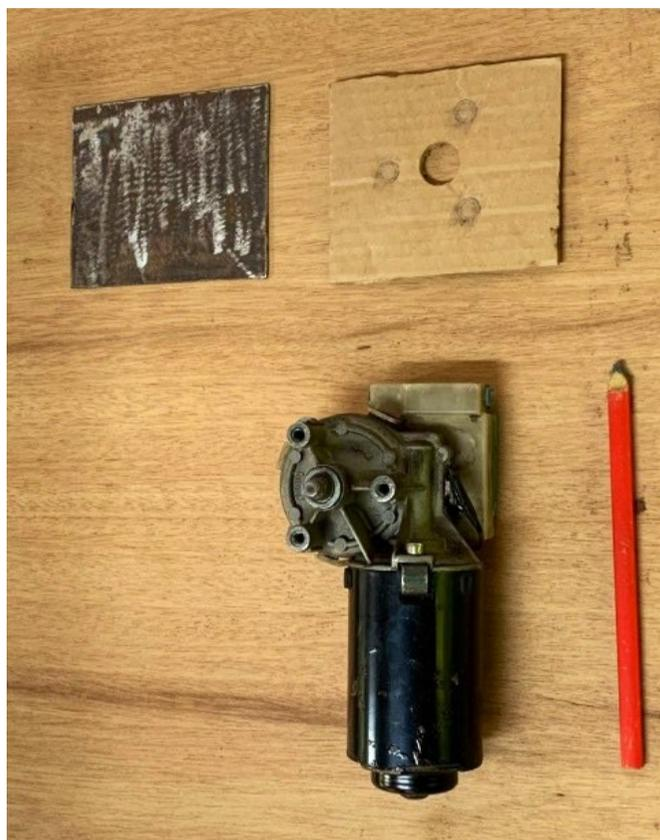
Alinhe a chapa metálica ao gabarito e fixe-as com fita crepe. Com ajuda de um punção e um martelo, marque os centros dos furos de fixação na placa metálica. Use um paquímetro para determinar o diâmetro dos parafusos de fixação, esse será o diâmetro dos furos a serem feitos na chapa metálica. Tenha cuidado para o furo não ficar muito maior do que a cabeça do parafuso pois pode comprometer a fixação do motor.
