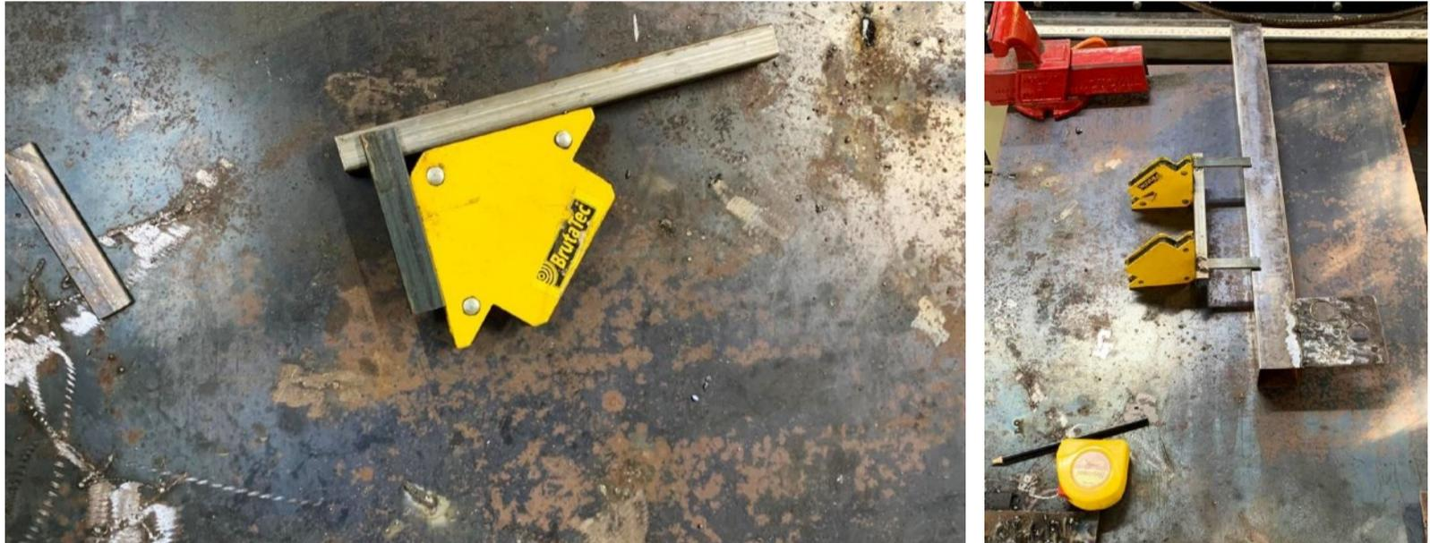
Teste o batedor dentro do guia para verificar se a cantoneira não bate no eixo principal da máquina. Se necessário, remova um ou dois milímetros da cantoneira com uma esmerilhadeira.
